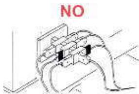
Non attaccare più di un apparecchio elettrico a una sola presa. In questo modo si evita che la presa si surriscaldi con pericolo di corto circuito e incendio **(VIETATO TASATIVAMENTE L'UTILIZZO DI PRESE TRIPLE).**
