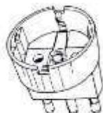
Spine di tipo tedesco (Schuko) possono essere inserite in prese di tipo italiano solo tramite un adattatore che trasferisce il collegamento di terra effettuato mediante le lamine laterali ad uno spinotto centrale. E' assolutamente vietato l'inserimento a forza delle spine Schuko nelle prese di tipo italiano. Infatti, in tale caso dal collegamento verrebbe esclusa la messa a terra.
